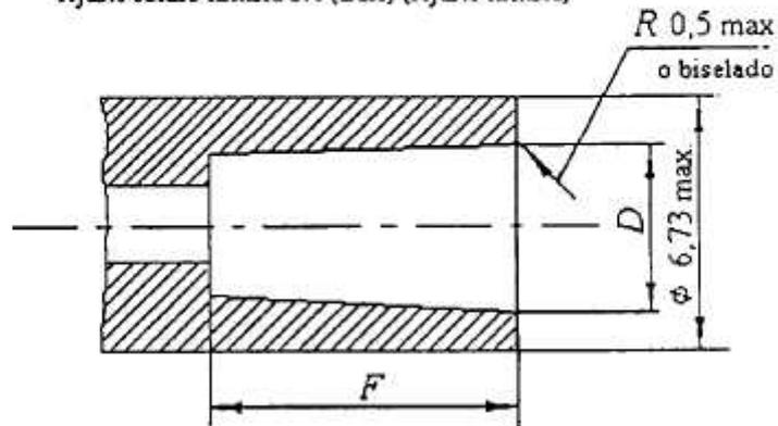
figura E.1.1: Ajuste cónico típico (Luer) del 6 %
