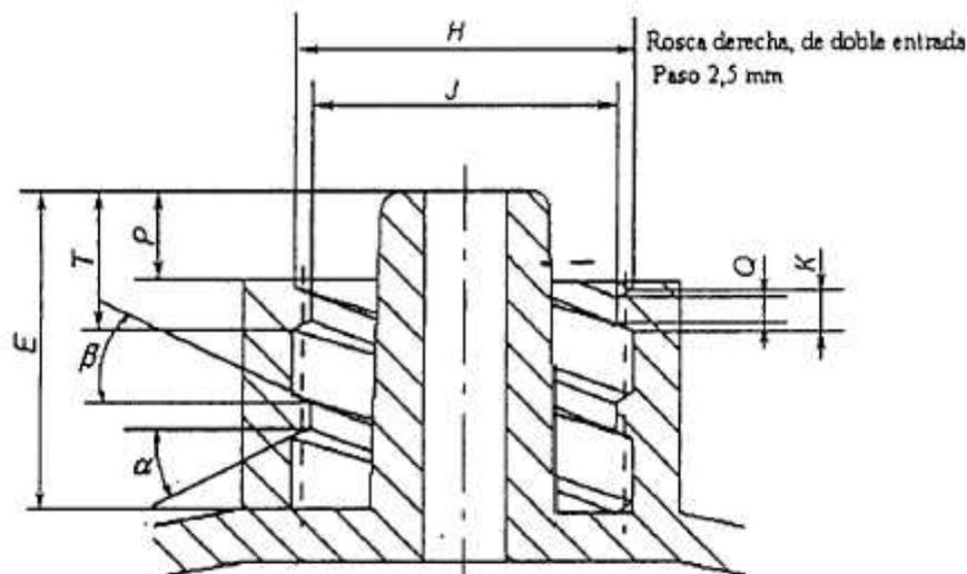
figura E.2.1 - Ajuste cónico fijado macho del 6% (Luer) con cuello internamente roscado permanentemente conectado
