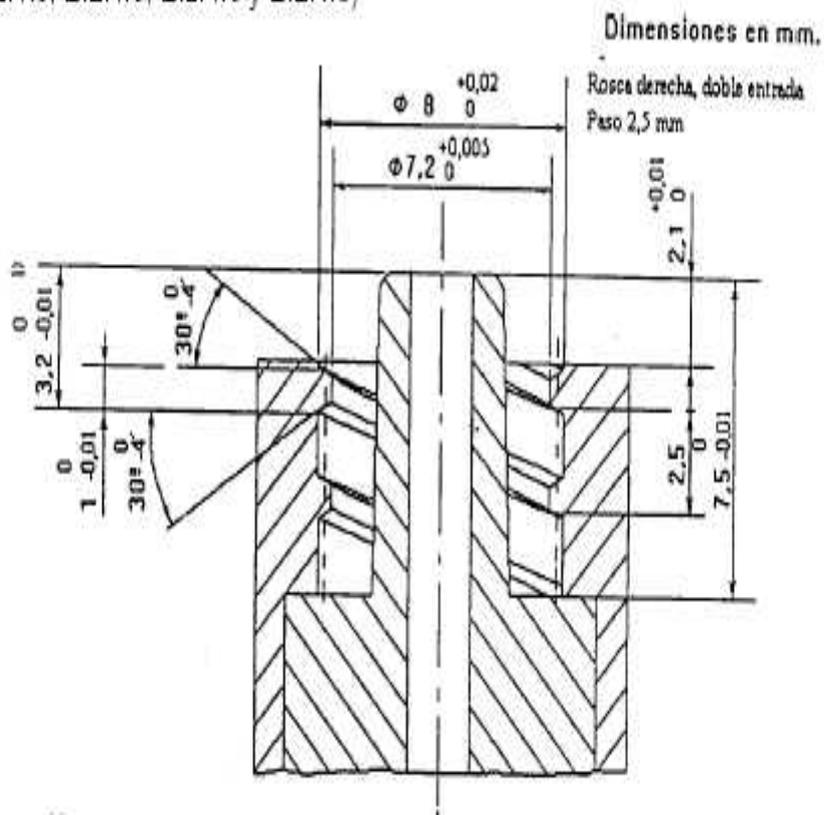
figura E.2.8: Ajuste cónico macho de referencia para evaluar ajuste fijado hembra con ahusamiento del 6% (Luer) para fuerza de separación y resistencia a la fatiga (ver E.2.4.4 y E.2.4.7).
