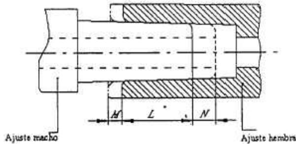
figura E.1.2: Ensamble típico del 6% del ajuste cónico (Luer)
